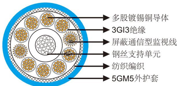
导体：DIN VDE 0295标准class 5柔软多股镀锡铜导体。
